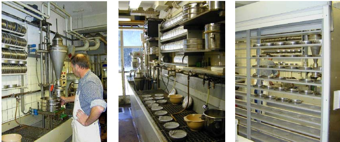
Figuur 15. Stappen in de extractie van nematoden uit grond
