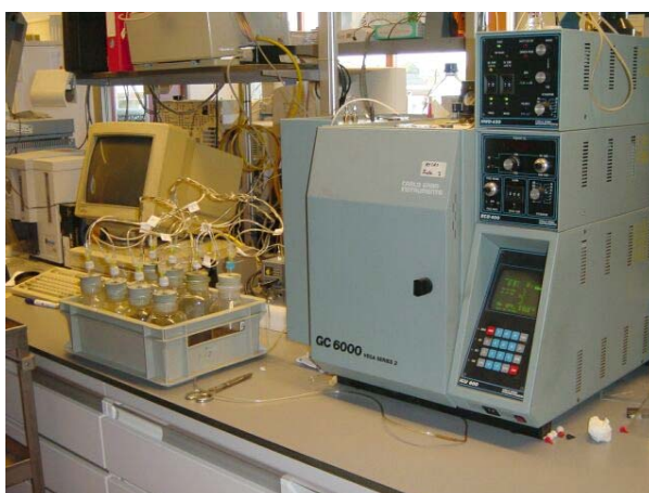
Figuur 13. Foto van opstelling waarmee de respiratie (zuurstofverbruik) wordt gemeten
