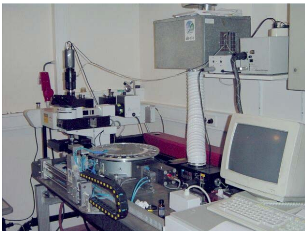
Figuur 11. Opstelling van confocale laser-scan microscoop voor automatische beeldverwerking
