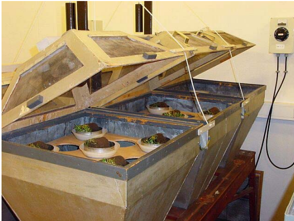
Figuur 18. Tullgrenapparaat voor de extractie van micro-arthropoden
